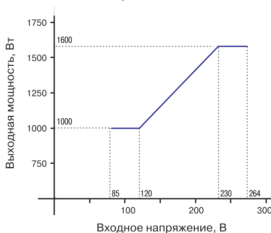
Рис. 3. Зависимость выходной мощности P_{\text{вых}} модулей серии AIF-PFC от входного напряжения
