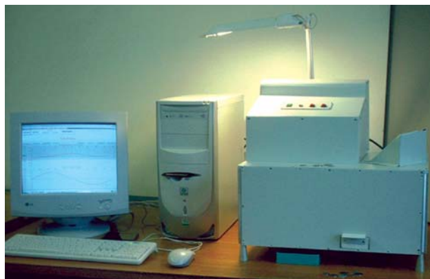
Рис. 1. Детектор электромагнитных и геометрических параметров монет
